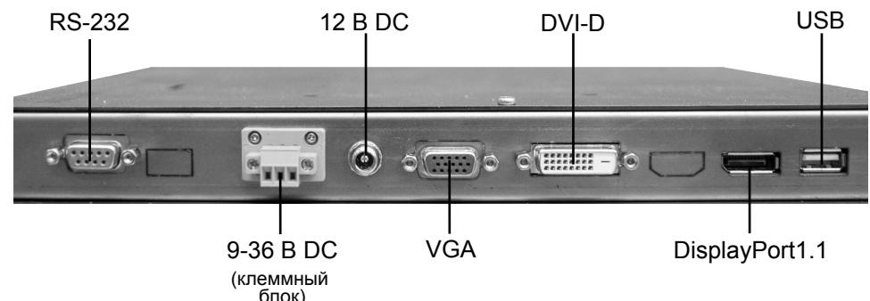
В первую очередь подключите и зафиксируйте все необходимые интерфейсные кабели (VGA, DVI, DP, USB, RS-232). Затем подключите обесточенный кабель питания. Монитор имеет два входа питания: трехконтактный клеммный блок для подключения к бортовой сети с постоянным напряжением 9-36 В и круглый разъем для подключения адаптера питания с выходным напряжением 12 В (идет в комплекте).
